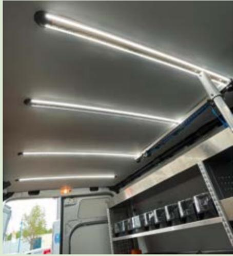
Zurrschiene mit integrierter LED-Beleuchtung
