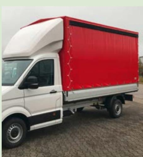
Plane/Spiegel Aufbau mit Zickzackverschluss, Schiebepane und Dachspoiler
