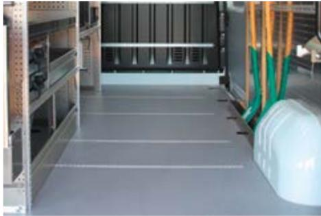
Fußbodenplatten, auf Wunsch mit eingefrästen Airlineschienen zur Ladungssicherung
