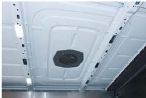
Vorgeschriebenen Be- und Entlüftung beim Transport von Druckgasflaschen
