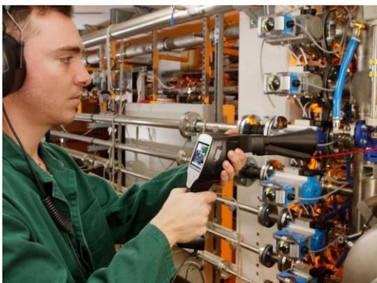
Der schalldichte Kopfhörer ermöglicht die Lecksuche auch bei extrem lauter Umgebung. Die Umgebungsgeräusche werden ausgeblendet, die Leckage (nicht hörbarer Ultraschall) wird in ein hörbares Signal gewandelt. Der Laser ermöglicht eine genaue Ortung.
