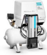
**LFXD:** Einstufiger, einzylindriger, ölfrei verdichtender Kolbenkompressor mit integriertem Adsorptions-Trockner und einem maximalen Betriebsüberdruck von 10 bar (145 psi).
