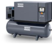
**LZ:** Einstufiger, ölfrei verdichtender Kolbenkompressor mit elektropneumatischer oder Elektronikon® MK5-Steuerung, schallgedämpft, mit einem maximalen Betriebsdruck von 10 bar (145 psi).
