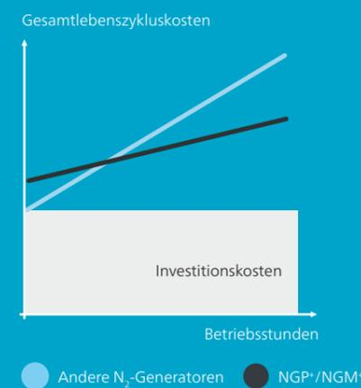
Mit einem Luftfaktor\* von 1,8 (bei 95 %) bis 5,5 (bei 99,999 %) und einer speziellen Energiesparregelung können die Betriebskosten des neuen NGP+ im Vergleich mit anderen N<sub>2</sub>-Generatoren um bis zu 50 % reduziert werden.
