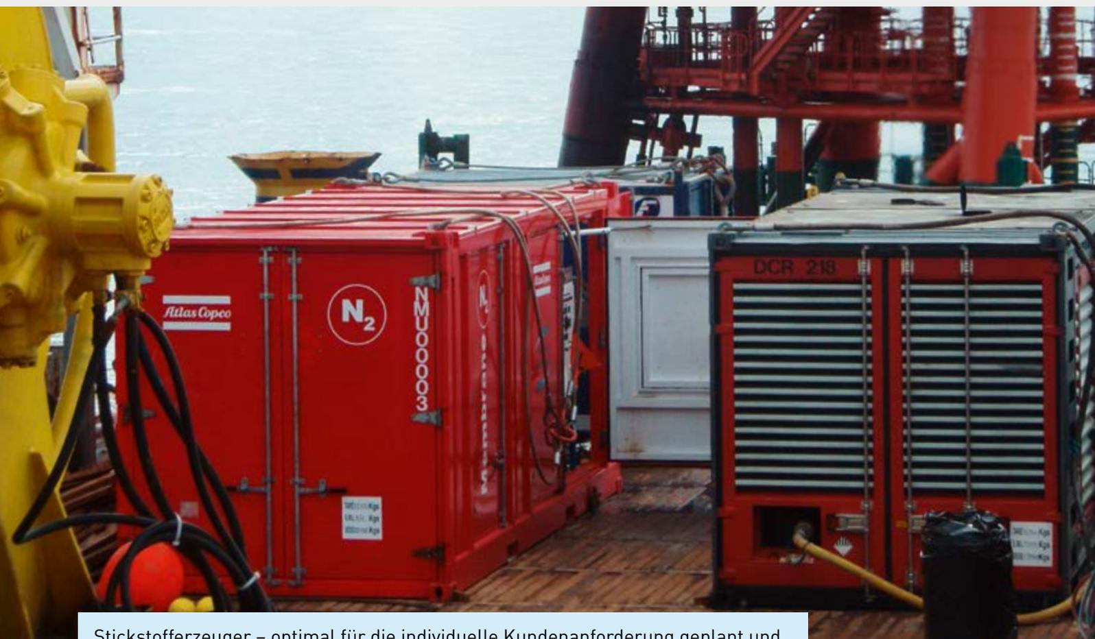
Stickstoffherzeuger – optimal für die individuelle Kundenanforderung geplant und installiert. Membrananlagen zur Stickstoffherzeugung mit einer Reinheit bis 99,9 %. PSA Anlagen zur Stickstoffherzeugung mit einer Reinheit bis 99,9999 %. Lieferung auch in GROSS-Airbox®-Anlagen möglich.
